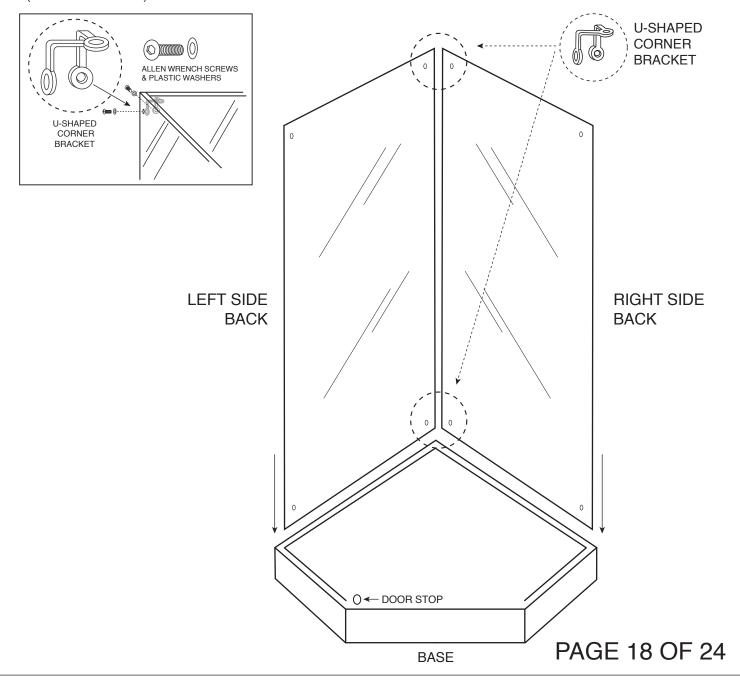
**STEP 3.** PLACE LEFT SIDE FRONT INTO SIDE BASE GROOVE OF CABINET BASE. MAKE CERTAIN ON BOTH BACK AND SIDE PANELS THAT YOU RECOGNIZE THE BOTTOM OF EACH PANEL CORRECTLY. (SEE PAGE 6).
